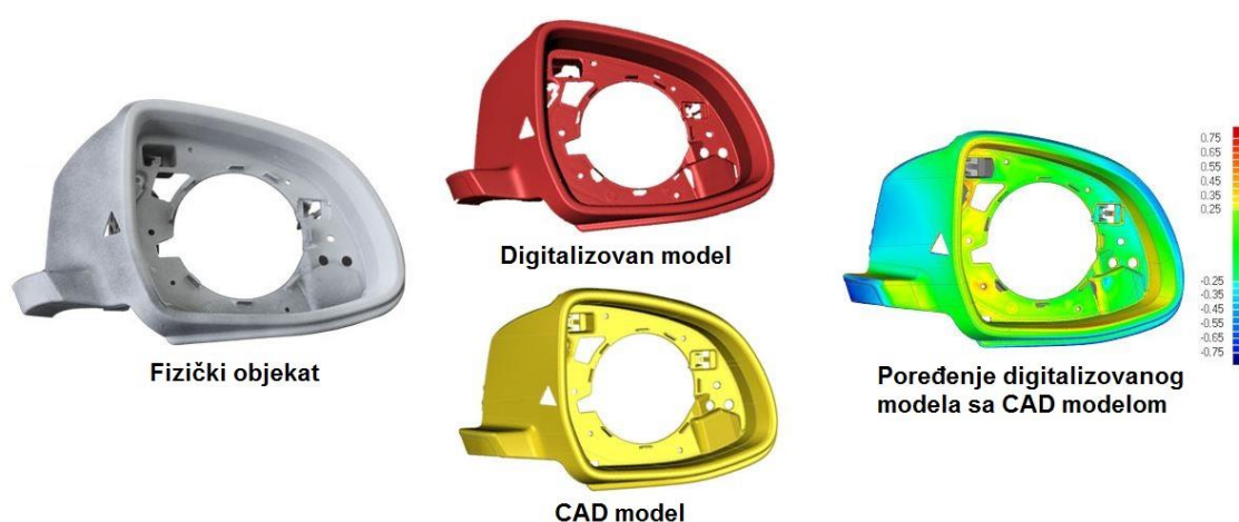
Slika 6.2. Osnovni tok CAD inspekcije [163].
