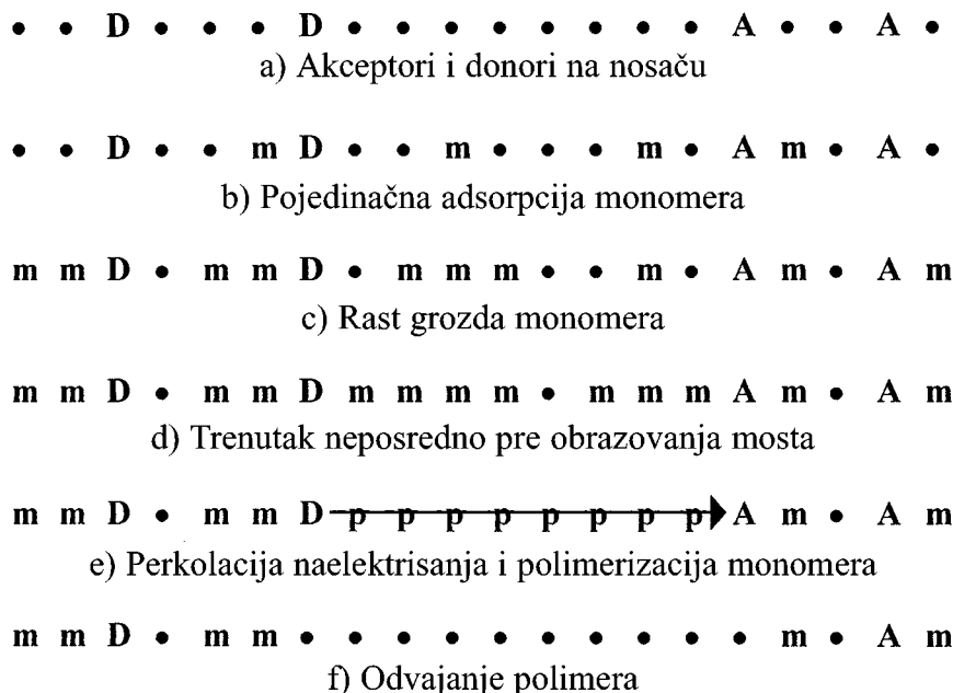
Slika 24. Faze osnovnog perkolacionog koraka (redosled dodavanja komponenata: nosač + prelazni metal + monomer) /donor (D), akseptor (A), prazna mesta na nosaču (•), adsorbovani (m) i polimerizovani (p) monomer, perkolacija naelektrisanja (→)/
