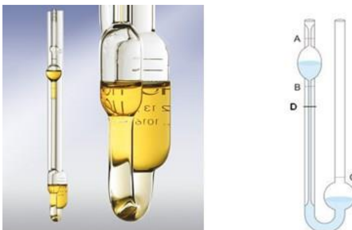
Slika 3.3 Osvaldov viskozimetar i njegov šematski prikaz
