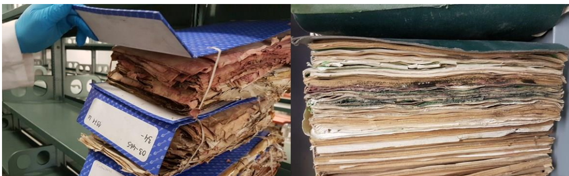
Slika 2.19 Biološki oštećena papirna građa sa vidnom pigmentacijom papirne površine i kontaktnim površinama prekrivenih gljivama, kao posledica velike relativne vlažnosti vazduha; ugroženi depoi Istorijaskog arhiva grada Novog Sada
