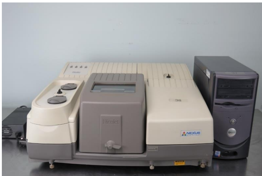
Slika 3.7 Aparatura za snimanje spektara u IC oblasti ( Thermo-Nicolet Nexus 670 )
