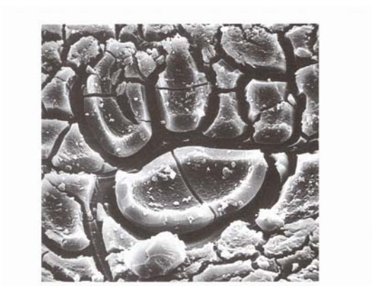
Slika 5. Korozija Sigradur ® -a K. 144 sati u 65%-oj azotnoj kiselini na 120°C.
