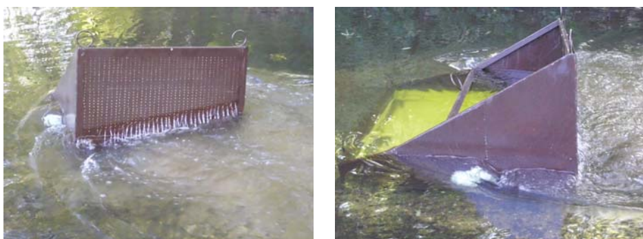
Конструкција и изглед хватача вученог наноса
