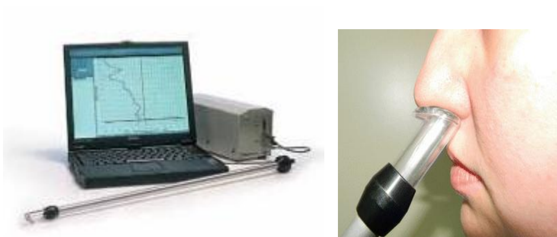
Слика 7. Риноманометар ( Rhinometrics SRE2000 Interacustics ) – опрема и начин мерења (преузето са: https://www.google.com/search?q=Rhinometrics+SRE2000+Interacustics&client=firefox-b-d&source=lnms&tbn=isch&sa=X&ved=2ahUKE )
