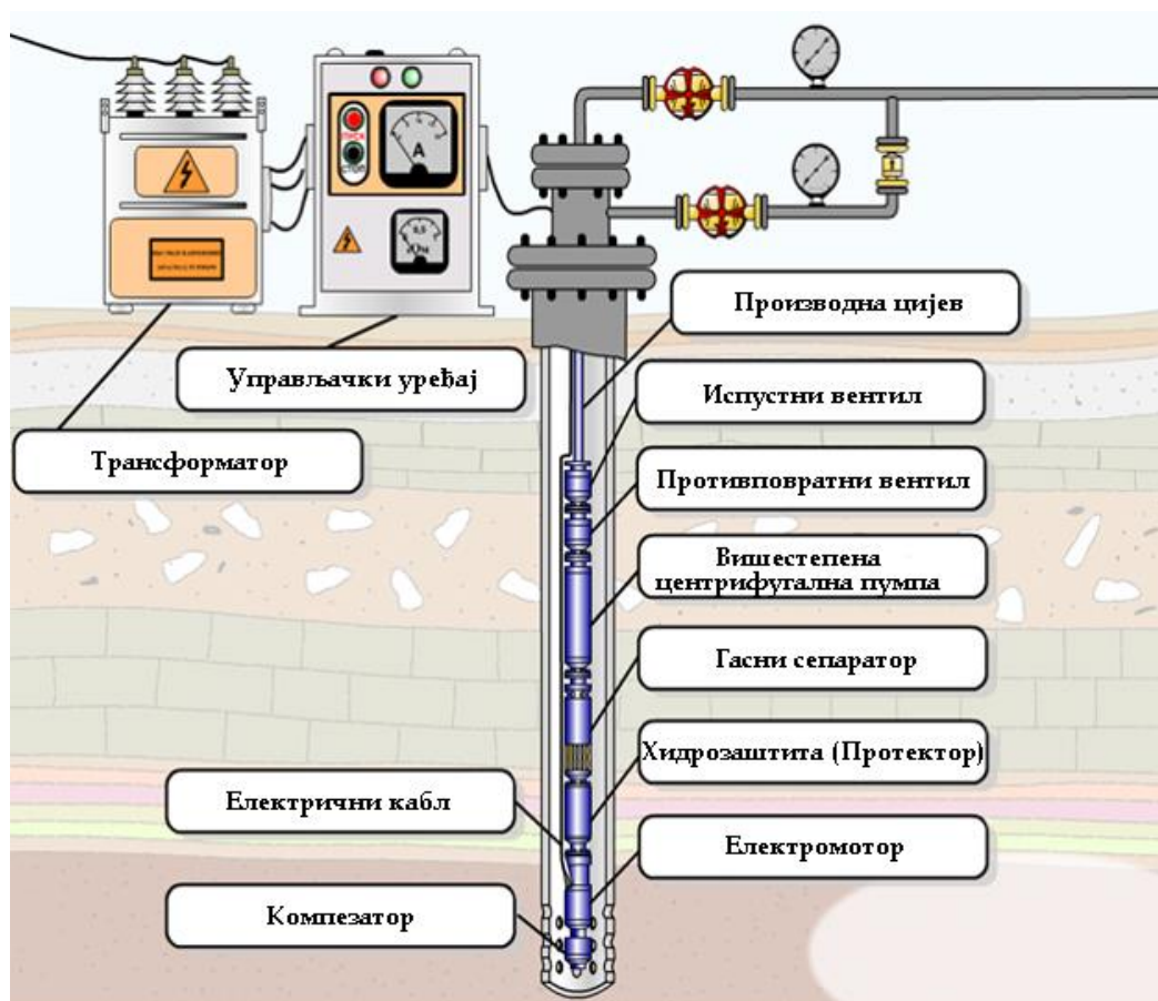
Слика 2.6 - Типична композиција ЕСП система (Добыча нефти и газа)
