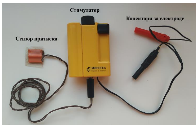
Слика 3.4. Минијатурни једноканални комерцијални систем за корекцију падајућег стопала MICROFES (Институт Јожеф Стефан, Љубљана, Словенија).
