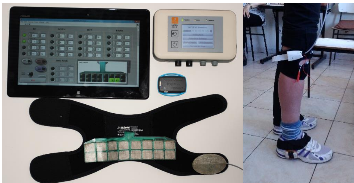
Слика 7.1. (а) Делови система за корекцију падајућег стопала: ИНТФЕС в2 стимулатор, инерцијални сензор, стезника за пателу са електродама, таблет рачунар са апликацијом за дефинисање виртуелних електрода за индуковање дорзифлексије и плантарне флексије скочног зглоба, и покретање протокола за асистенцију хода (б) систем на пацијенткињи.
