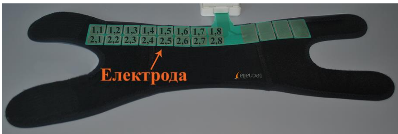
Слика 4.3. Друга верзија електроде и комерцијални стезник за пателу. Анода се састоји од 4 дела (десна поља) и интегрисана је са пољима који имају улогу катоде (левих 16 поља). Координате поља која имају улогу катоде су исписане на њима.
