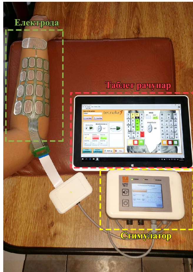
Слика 12.1. Систем за рехабилитацију горњих екстремитета који се састоји од стимулационе јединице ИНТФЕС v2, ергономске електроде која се састоји од шеснаест поља који имају улогу катоде распоређених тако да покривају зоне од интереса за индуковање екстензије зглоба, прстију и палца и једног поља који има улогу аноде које се поставља у непосредној близини зглоба, и апликације на таблет рачунару за контролу система преко Bluetooth-a .
