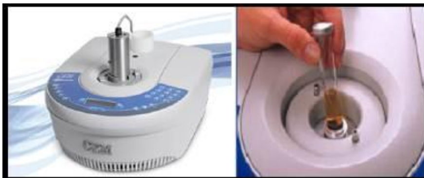
Slika 2.11. Mikrotalasni reaktor sa dodatnom opremom za izvođenje reakcija pod povišenim pritiskom
