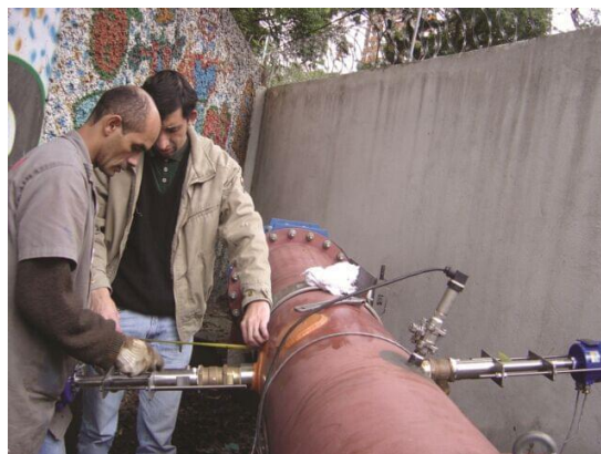
Slika 2.4 Levo) EM senzor brzine u toku Valeport 801 (preuzeto sa www.valeport.co.uk ); Desno) Kontrola položaja ubodnih EM senzora unutar vodovodnog cevovoda ( preuzeto sa www.pilotflow.com )
