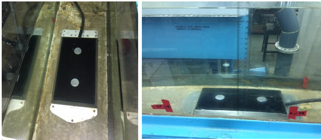
Slika 4.2 Fotografije sa ispitivanja rada Flat DC-2 (ravnog) EM senzora u okviru hidrauličke laboratorije, Građevinskog fakulteta, Univerziteta u Beogradu.
