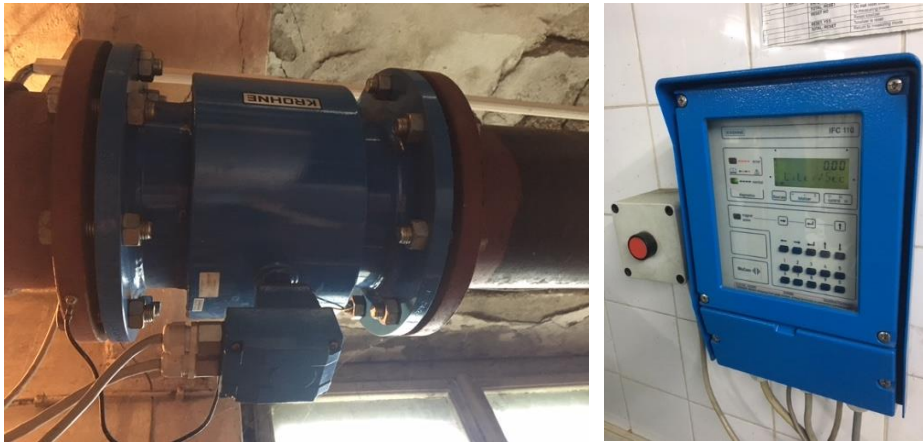
Slika 3.12 Levo) EM senzor protoka Aquaflux F/6 na potisnom cevovodu u podrumu hidrauličke laboratorije; Desno) Pretvarač, logger i displej IFC 110 u prizemlju hidrauličke laboratorije
