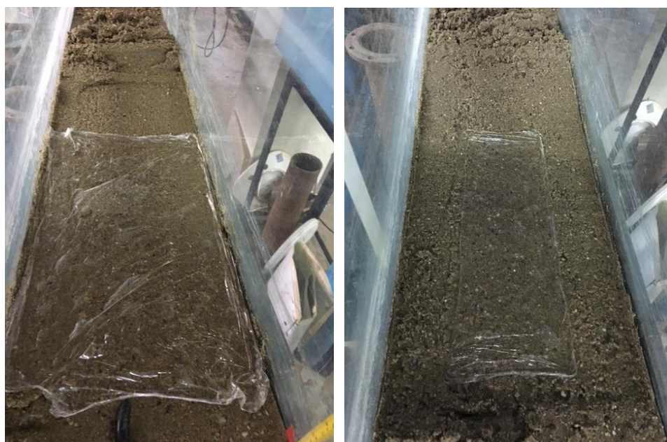
Slika 4.11 Prikaz pozicija listova plastične folije iznad Flat DC-2 (ravnog) EM senzora za varijante: Levo) g = 1 - Dimenzije lista plastične folije 280 * 250 mm, Desno) g = 2 - Dimenzije lista plastične folije 280 * 125 mm
