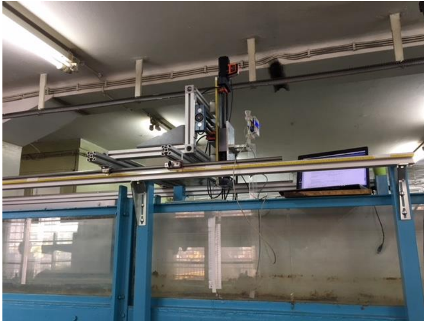
Slika 3.13 Mapiranje magnetnog polja Flat DC-2 EM senzora brzine uz pomoć automatizovanog pozicionera i Melexis MLX90393 Magnetometra
