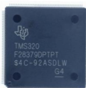
Сл. 10.2 TMS320F28379D микроконтролер (MCU) произвођача Texas Instruments [105]
