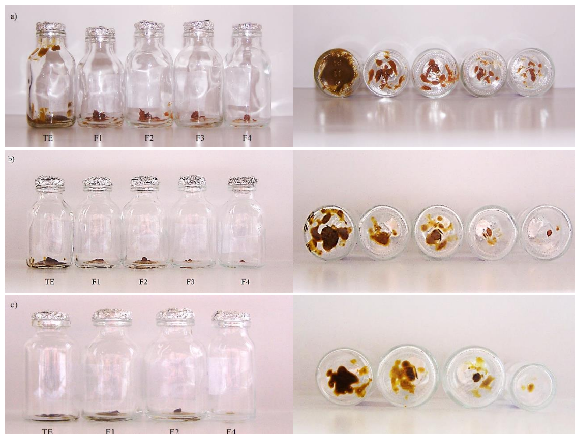
Slika 53. Totalni ekstrakt označen kao TE i ekstrakti izolovani nakon svakih 60 minuta označeni kao F1, F2, F3 i F4 vršnih delova industrijske konoplje dobijeni ekstrakcijom ugljendioksidom u superkričnom stanju pri konstantnom pritisku od 100 bar i temperaturi: a) 40 °C, b) 50 °C i c) 60 °C
