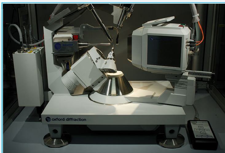
Slika 3.9. Uređaj za rendgensku kristalografiju ( Gemini S )
