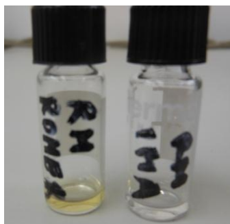
Slika 4.6 Izgled ekstrakta RM1 nakon prečišćavanja na MycoSep® 231 Fum kolonama (ROMER) i FumoniTest™WB (IMA) kolonama.
