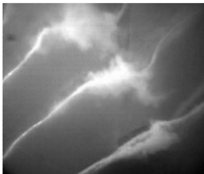
Slika 2.7. Razbijanje vrha kavitacionih vrtloga [78].
