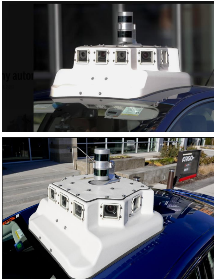
Slika 2.5. Foto senzor i niz kamera na jednom od test vozila kompanije Argo AI, Fordove jedinice autonomnih vozila, u Pittsburgu [23].
