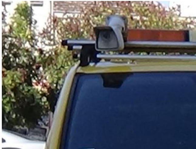
Slika 5.1. Kamera na krovu vozila za snimanje puteva Centra za motorna vozila, AMS Srbije.
