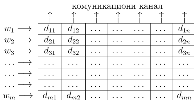
Слика 3.5: Илустрација блоковског интерливера.
