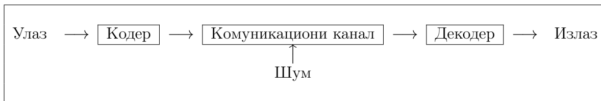
Слика 3.1: Илустрација модела комуникационог канала са заштитним кодерима.
