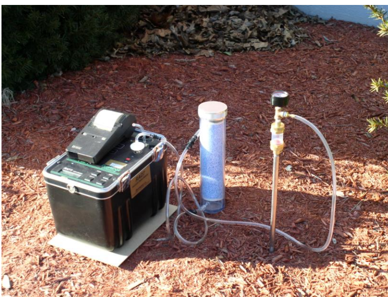
Slika 4.7 Merni komplet RAD7 za merenje emanacije radona iz zemljišta [74]
