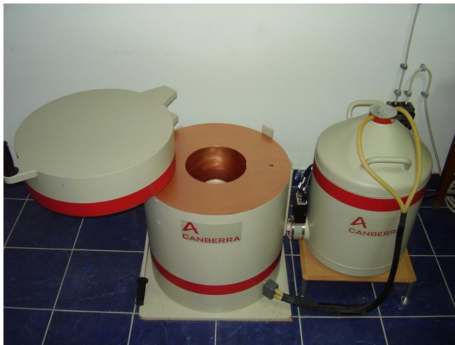
Slika 5.6 Gama spektrometar tipa GX10021, oznake kartona B, relativne efikasnosti 100%
