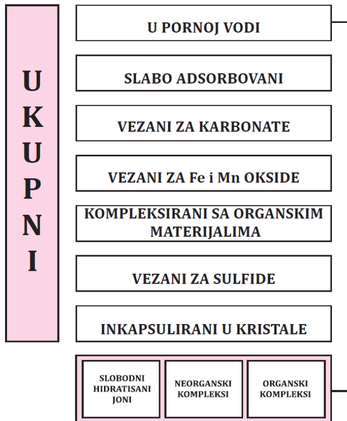
Slika 2. Vezivanje metala u čvrstoj fazi
