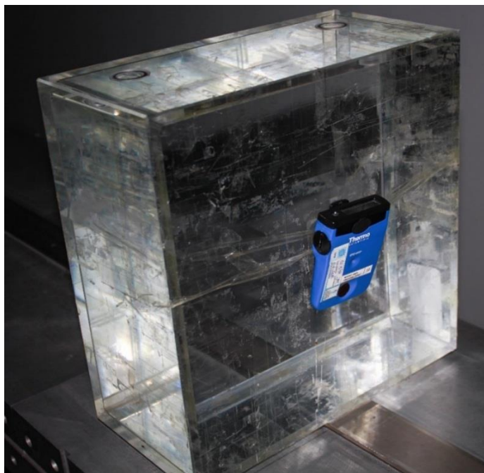
Слика 8.1. Електронски лични дозиметар (EPD) типа EPD Mk2 (Thermo Scientific) постављен на стандардни ISO водени блок фантом. Ентитет фантом-дозиметар је центриран и постављен на калибрациону клупу тако да се референтна тачка дозиметра налази на растојању 2 m од извора зрачења.
