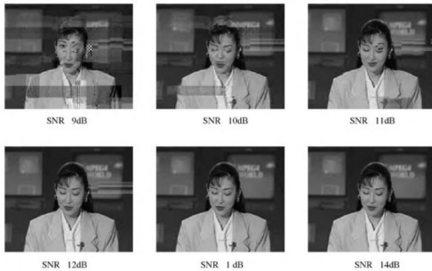
Слика 2.28. деградација слике услед оштећења MPEG-4 битстрим-а преко AWGN канала користећи BPSK модем у фрејму 144x176-пиксела QCIF “Акиџо” секвенце. BER у фрејму овог фрејма при SNR били су између 10^{-7} и 10^{-3} , док се PSNR кретао од 41,74 dB до 19,27 dB.
