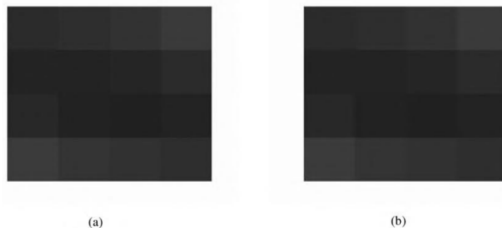
Слика 3.9: Поређење 4x4-пиксела под-блока издвојеног из “Фореман” секвенце, где је (а) оригинални 4x4-пиксела под-блок пре трансформације и квантизације, а (б) је реконструисани 4x4-пиксела под-блок након што је прошао кроз Н.246 стандардне процесе целобројне трансформације и квантизације.
