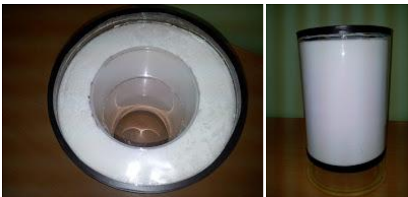
Slika 62 Izgled velikog Marinelli suda ispunjenog uzorkom
