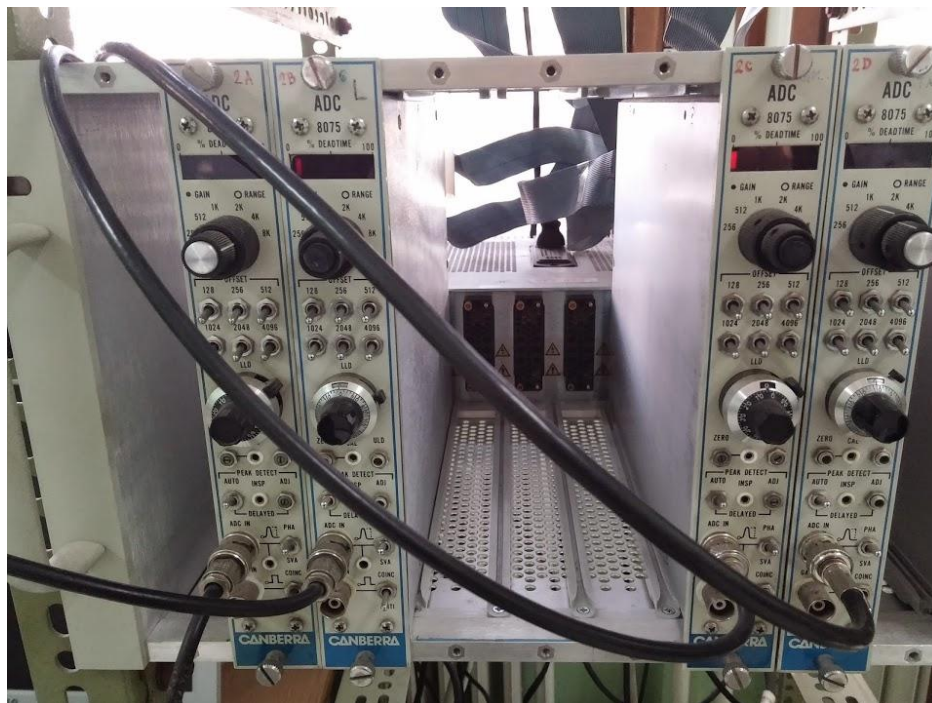
Slika 53 Četiri ADC-a koji prikupljaju signale iz dva plastična scintilatora, germanijumskog detektora i TAC-a
