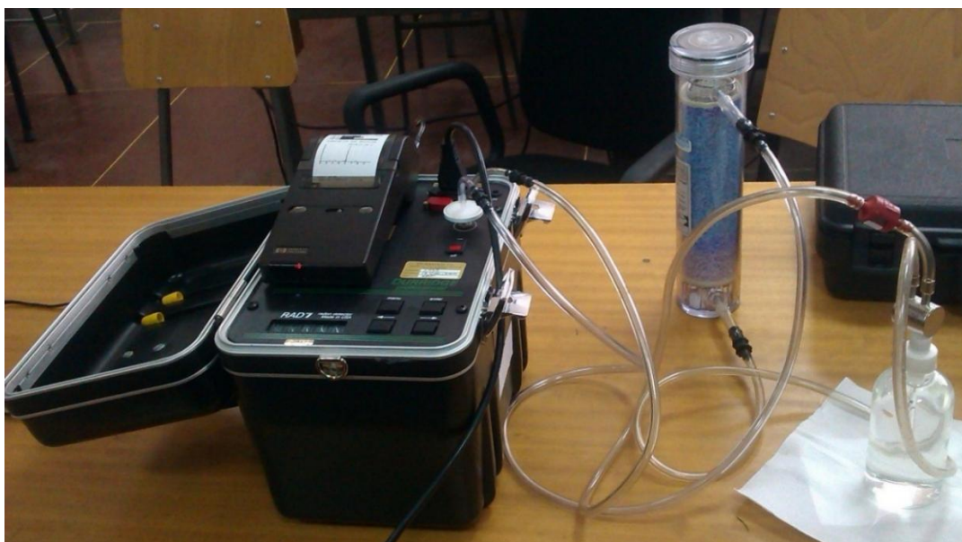
Slika 5.3. Merenje aktivnosti radona u uzorku vode RAD7 alfa spektrometrom (PMF, UNS)
