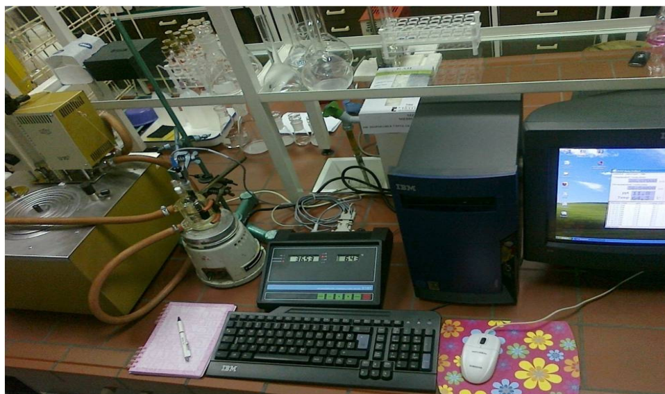
Slika 3.3. Aparatura za merenje električne provodljivosti
