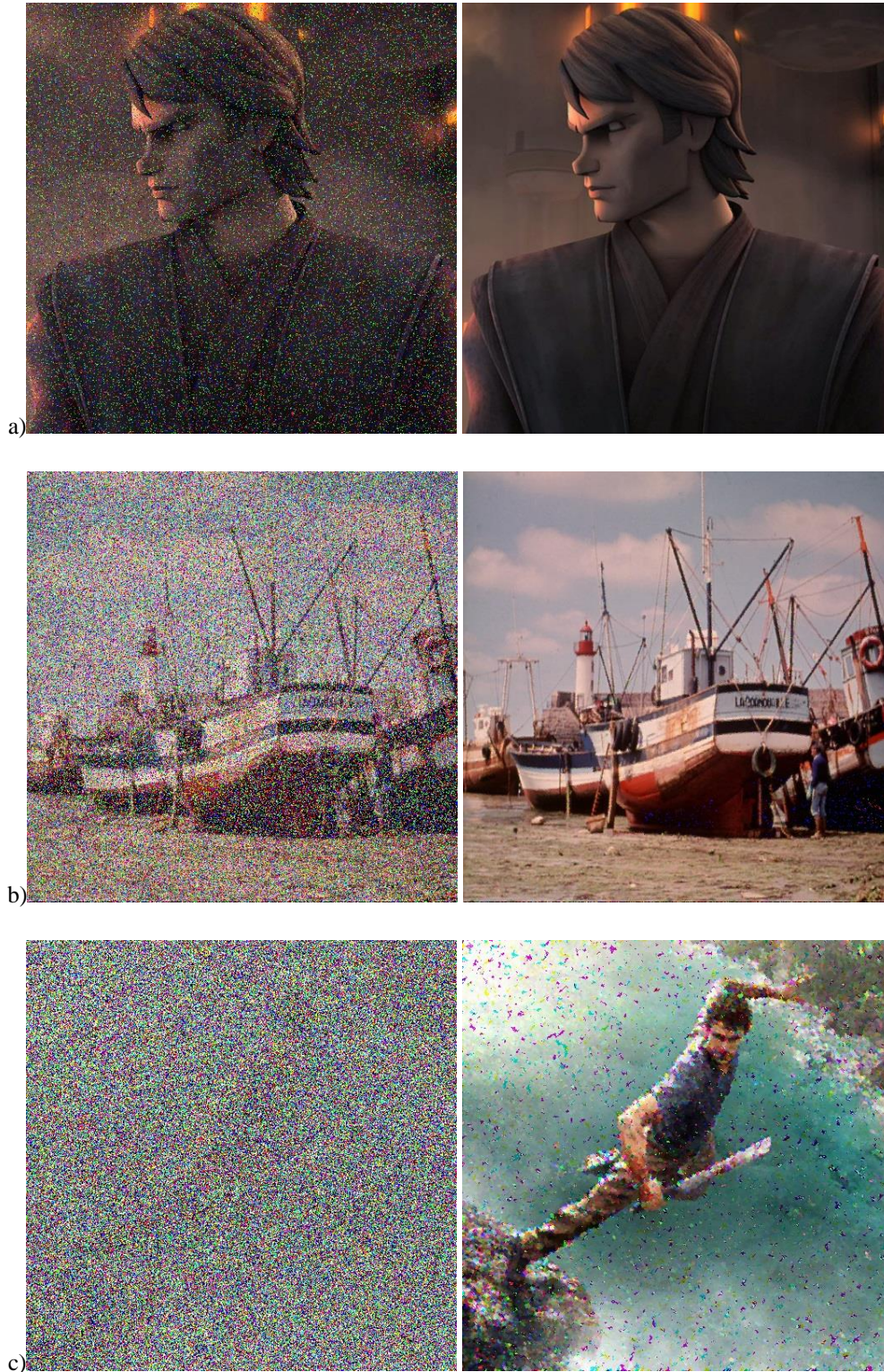
Slika 9.17. Slike sa dodatim Salt & Pepper šumom i rezultat redukcije Regeneration filterom za: a) 10% šuma, b) 40% šuma i c) 90% sa prvom interakcijom.
