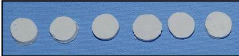
Слика 11. Изливени профили узорка цемента
