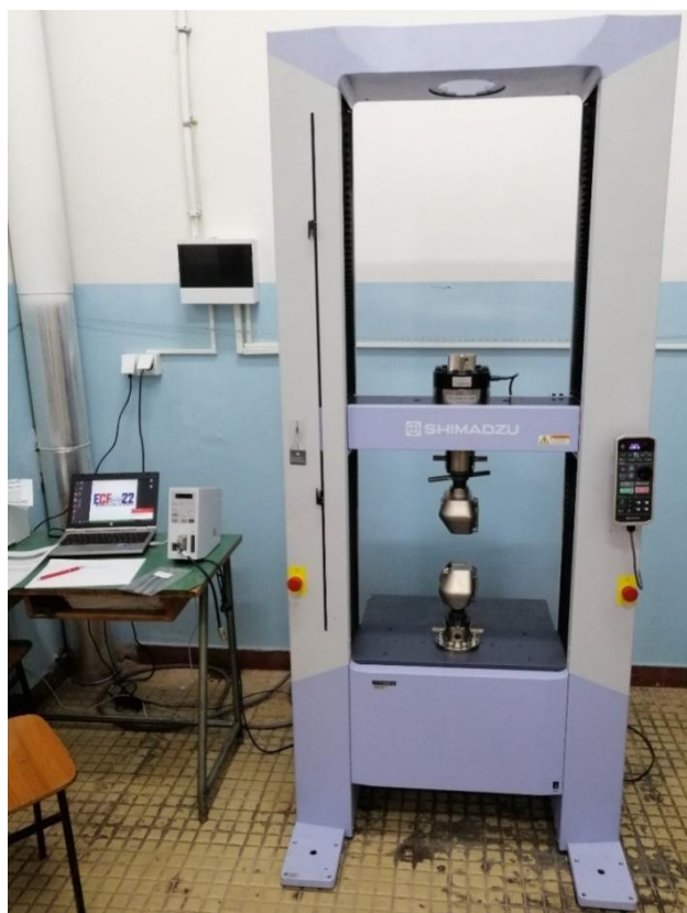
Слика 16. Кидалица ( tensile testing machine, eng. ) Shimadzu AGS-X
