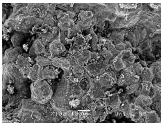
Slika 4. 25a. SEM vezivni materijal 1, Trajanov most, Kostol, x100, 100µm
