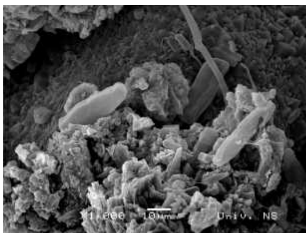
Slika 4. 25g. SEM vezivni materijal 1, Trajanov most, Kostol, x1000, 10 \mu m
