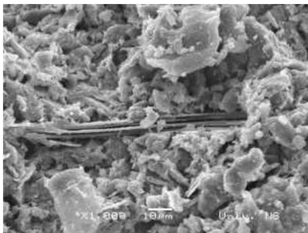
Slika 4. 31d. SEM opeke, Medijana, x1000, 10µm
