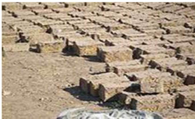
Slika 1. 9. Izgled nepe ene opeke, sušenje na Suncu
