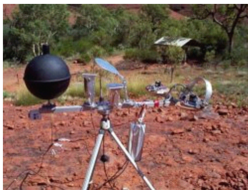
Slika 4.2 Uređaj za merenje WBGT (Australijski meteorološki zavod, 2011).
