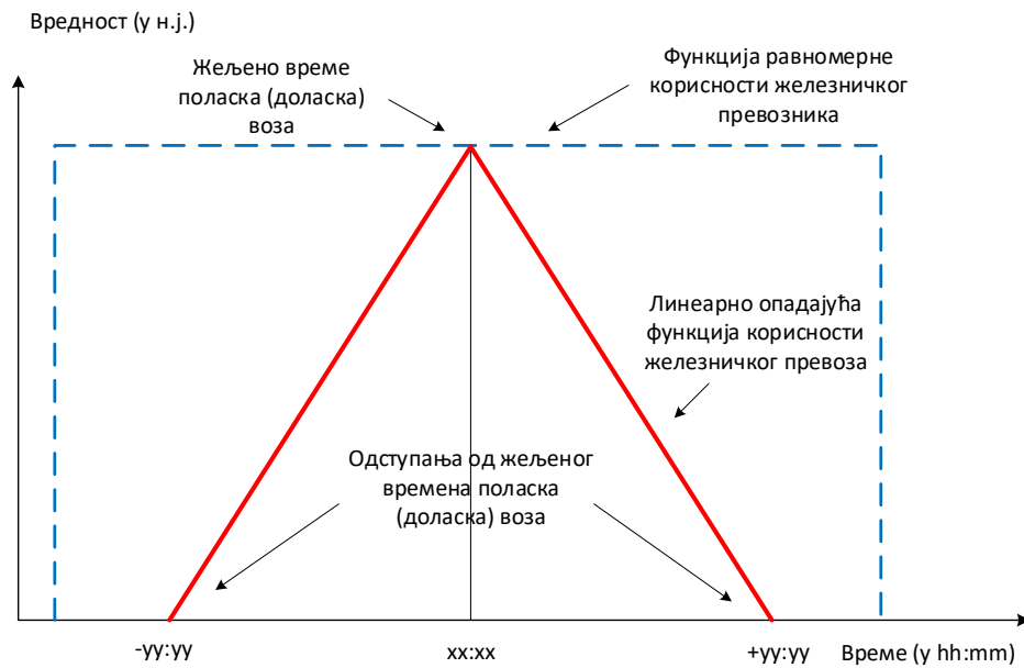
Слика 10 Функција корисности трасе за железничког превозника у односу на одступање од жељеног времена саобраћања воза
