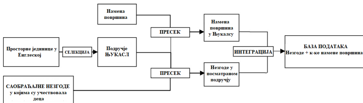
Слика 4.12. Интеграција података у циљу испитивања везе између намене површина и саобраћајних незгода у Њукаслу (Dissanayake et al., 2009)
