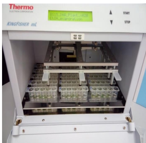
Слика 4. Робот за изолацију нуклеинских киселина KingFisher mL ( Thermo ) (Извор: фотодокументација А. Савић)
