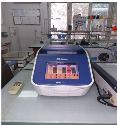
Слика 6. Апарат за ланчану реакцију полимеразе Veriti Thermal Cycler ( Life Technologies ) (Извор: фотодокументација А. Савић)
