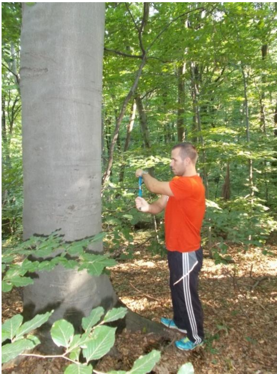
Слика 5: Вађење извртака из стабла преслеровим сврдлом
