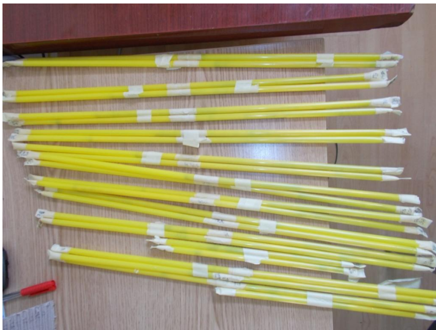
Слика 6: Паковање извртака на терену
