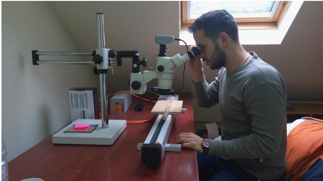
Слика 9: Скенирање извртака помоћу Atrics система
