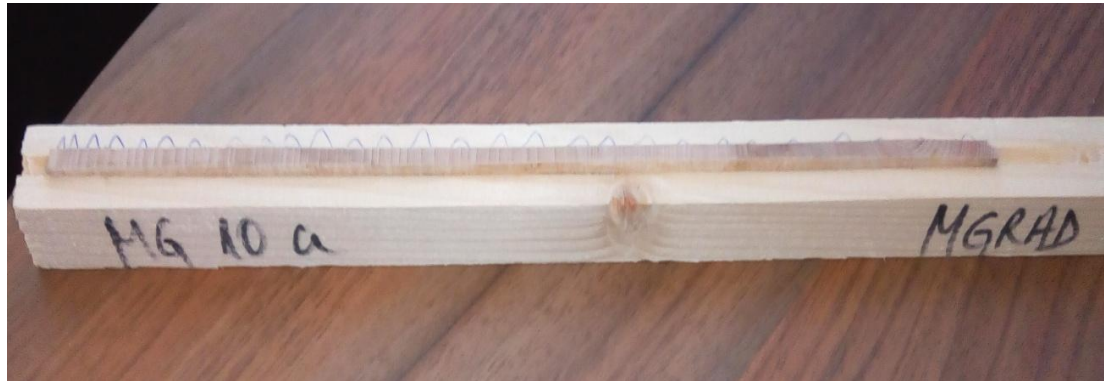
Слика 8: Постављен и избрушен извртак стабла букве припремљен за скенирање
