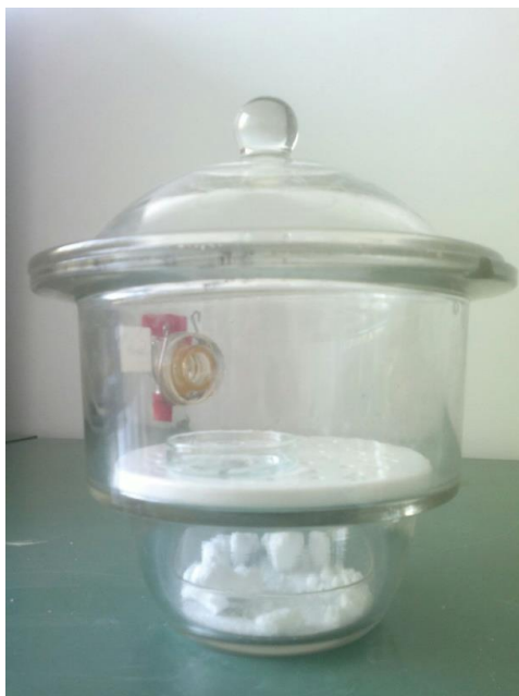
Слика 3.2. Апаратура за припрему серије узорака ВПМ- \text{CaCO}_3 -X (X=1-5)
