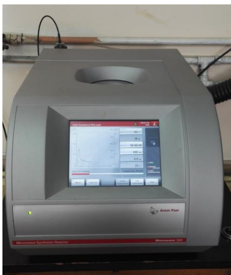
Slika 2.8. Mikrotaladni reaktor korišćen za pretretman obezmašćenog sojinog brašna
