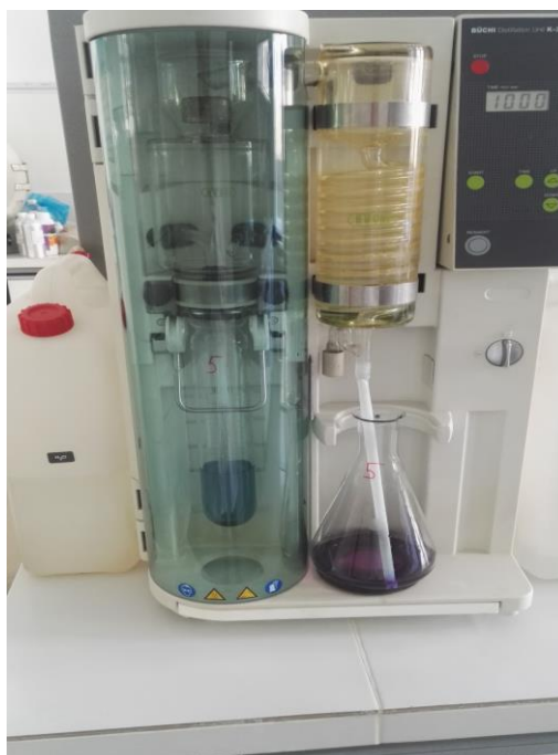
Slika 3.8. Izgled destilacione jedinice korišćene u ovom istraživanju sa pripremljenim uzorkom za destilaciju
