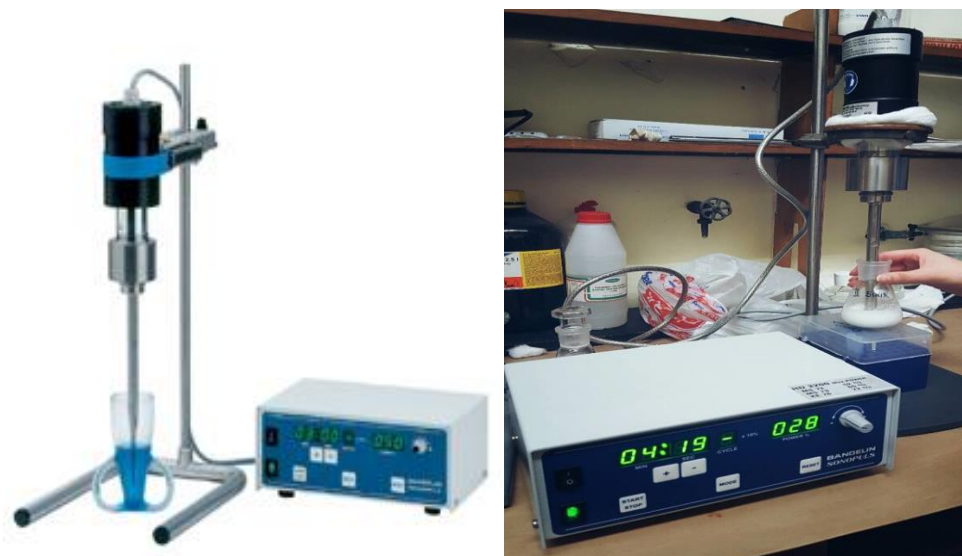
Slika 2.10. Ultrazvučni homogenizator Sonoplus, frekvence 20 kHz, ultrazvučna sonda tip VS70T (levo); Ultrazvučni pretretman pripremljenih uzoraka obezmašćenog sojinog brašna (desno)
