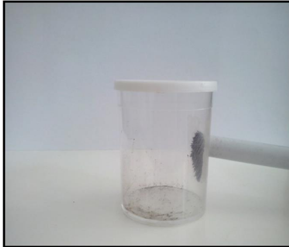
Slika 7. Ponašanje MPEG200003.1 praha u prisustvu magneta.
