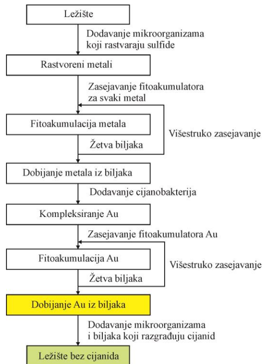
Slika 3.5. Predloženi postupak za dobijanje metala (Maluckov, 2015b).
