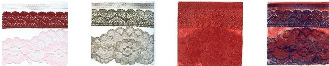
С лева на десно: а) Узорак материјала; б) Висока штампа; в) Дубока штампа; г) Комбинована штампа
