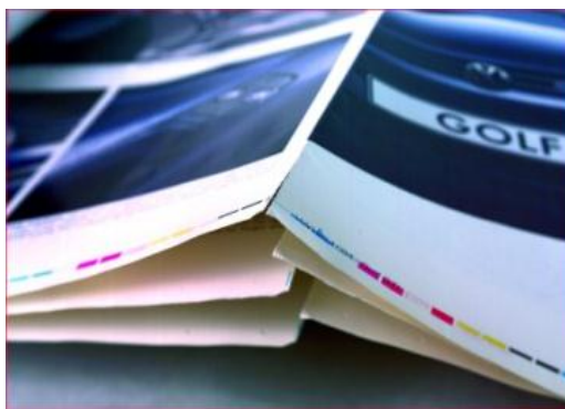
Slika 5.5 – Izgled greške prekida papira nakon savijanja u rotacionoj štampi (Fogra, 2014)
