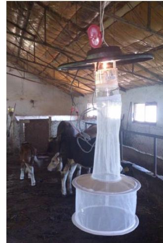
Slika 27. Standardna CDC klopka (Foto: Slavica Vaselek)
