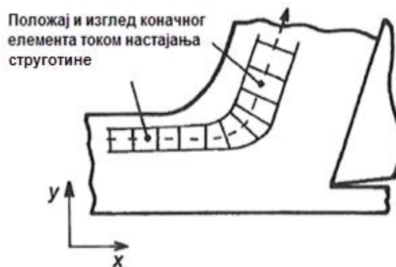
Слика 4.4. Ојлерова формулација у примарној зони смицања [54]
