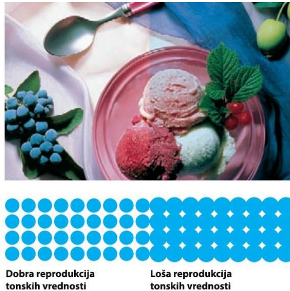
Slika 2.26. Izgled štampanog otiska: pravilno reprodukovane TV (leva polovina) i otiska sa prekomernim PTV (desna polovina) (Heidelberger Druckmaschinen AG, 2008)
