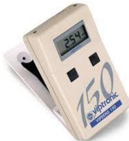
Slika 5.2.9: Izgled korišćenog uređaja za kontrolu kvaliteta filma
