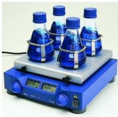
Slika 5.2.4: Izgled korišćene mašine za homogenizaciju boje i veziva
