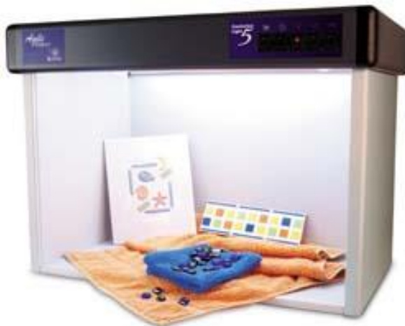
Slika 5.2.17: Uređaj za posmatranje uzoraka - Agile Radiant Controlled Light [Cherlyn, 2013]
