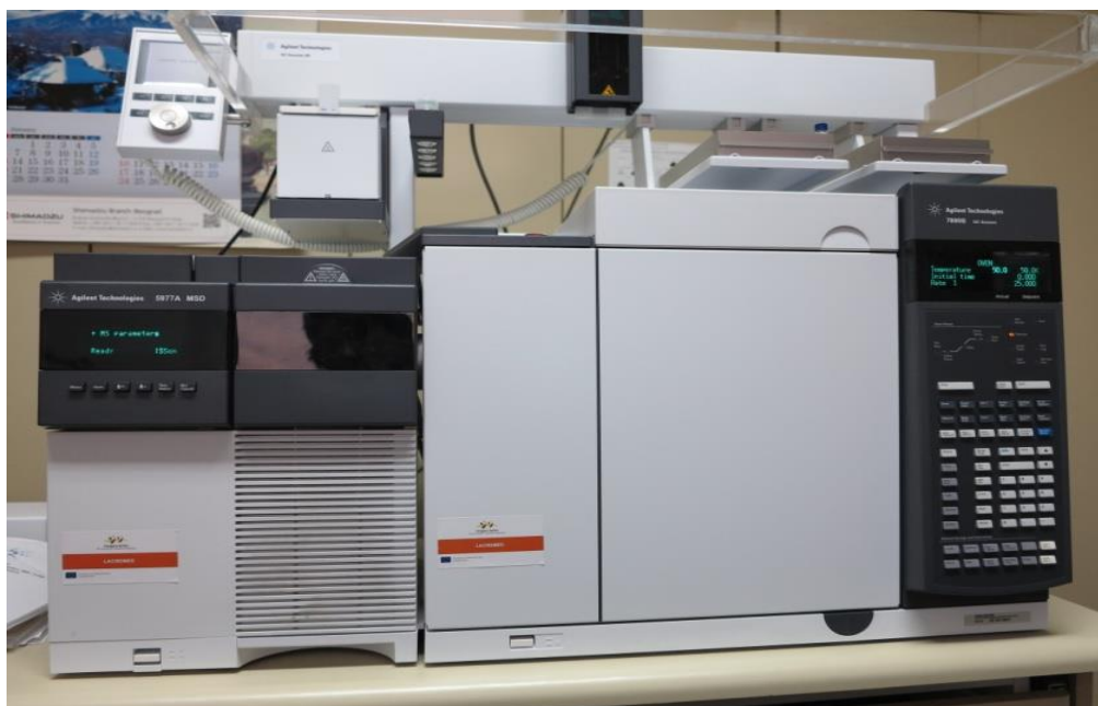
Слика 3.5 Гасни хроматограф са масеним детектором Agilent 7890B/5977MSD у Лабораторији за хемијске контаминенте и одрживи развој Технолошког факултета Нови Сад
