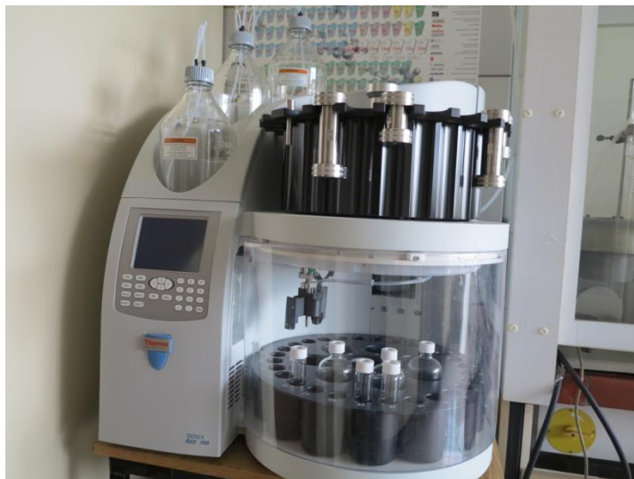
Слика 3.2 Аутоматски екстрактор ASE350, Dionex, Thermo Scientific, у Лабораторији за хемијске контаминенте и одрживи развој Технолошког факултета Нови Сад
