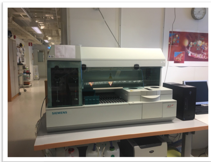
Слика 1. BCS® XP System апарат за колорифотометријско одређивање ендогеног тромбин потенцијала
