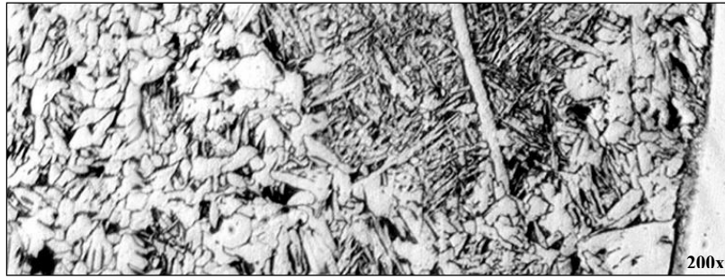
Слика 4.15. Микроструктура ЗУТ-а узорка навареног са јачином струје I=80A
