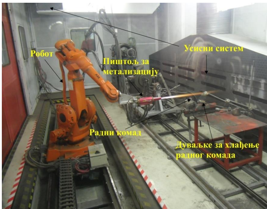
Слика 2.30. Комора за HVOF метализацију
