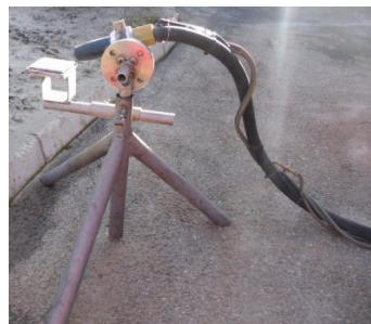
Слика 3.6. Шематски приказ ерозионог теста: 1) компресор, 2) еродент, 3) пиштољ, 4) млазница, 5) носач, 6) узорак; \alpha – угао наструјавања Слика 3.7. Део инсталације пре ерозионог теста
