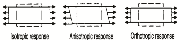
Слика 5.1. Понашање изотропних, анизотропних и ортотропних материјала при дејству силе затезања
