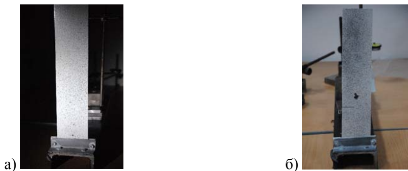
Слика 4.2. Алуминијумска плоча; а) здрава и б) оштећена
