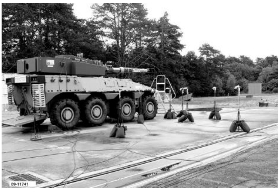
Сл. 2.13 – Распоред мерне опреме у циљу мерења натпритиска око самоходног топа 120 mm
