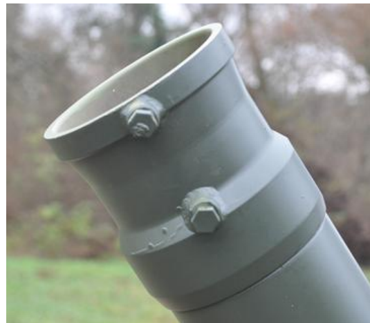
Сл. 5.2 – Цилиндрично-дивергентни наставак цеви са мерним местима М1 и М2 за мерење притиска (модел и опитни уређај)
