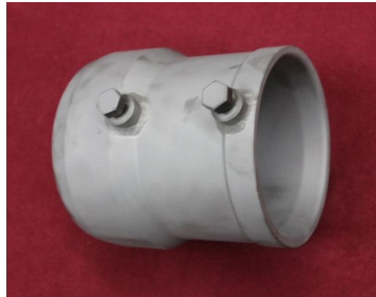
Сл. 5.1 – Цилиндрични наставак цеви са мерним местима М1 и М2 за мерење притиска (модел и опитни уређај)
