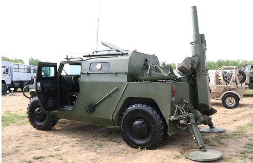
Сл. 5.8 - "Тигар" - Самоходни минобацачки систем 120 тт интегрисан на точкашкој шасији погона 4x4, са стопама за ослањање
