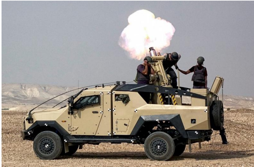
Сл. 5.10 - "SPEAR MK2" потпуно аутономан минобацачки систем калибра 120 мм интегрисан на точкашкој лако-оклопљеној шасији погона 4x4 (HMMWV, JEEPS) са ефикасним хидроеластичним системом који обезбеђује висок ниво редуције силе на подлогу, укупне масе без аутоматског пуњача је 200 кг, производи Elbit Systems
