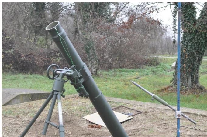
Сл. 7.3—Приказ постављања сонде за мерење натпритиска на месту нишанције, непосредно уз цев минобацача, мерно место ММ4
