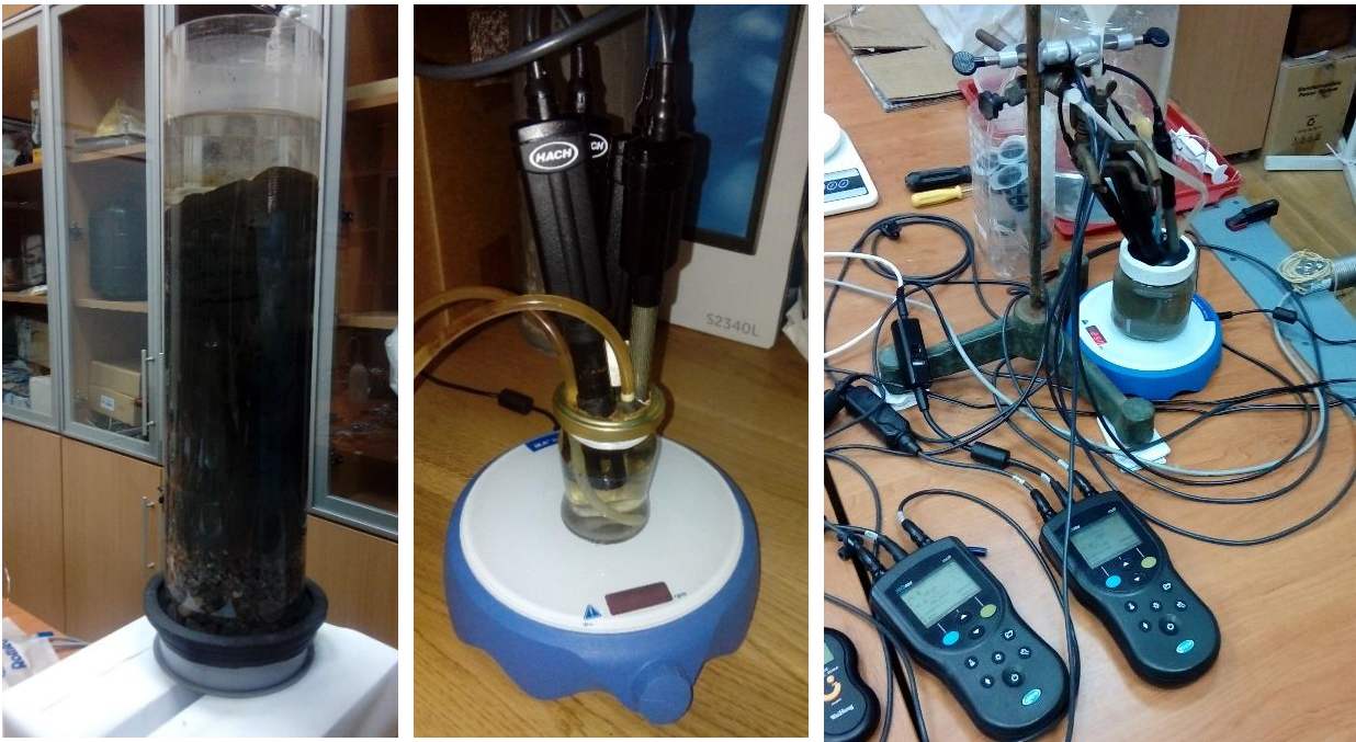
Slika 3.16 Kolona sa vodozasićenim zemljištem sa područja Kovin-Dubovac, sa logerima, sondama, protočnom ćelijom i vagama sa logerima
