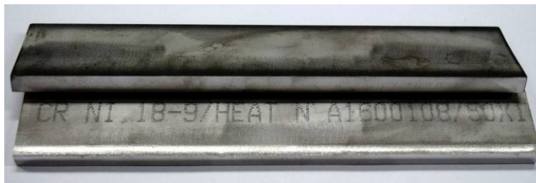
Slika 3.42 Ploče sa pripremljenom ivicom
