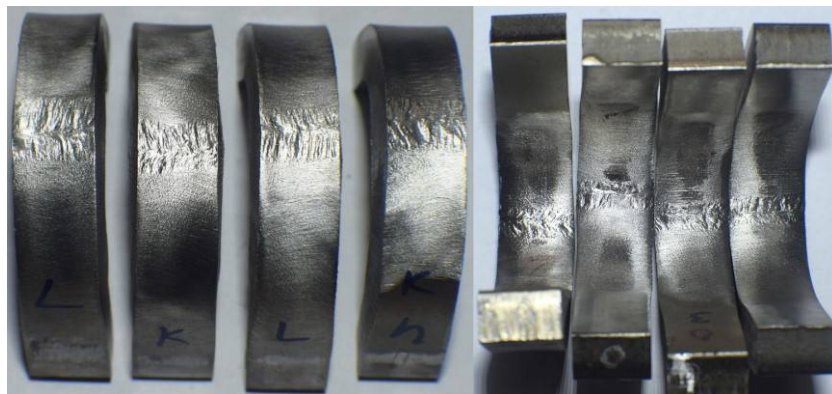
Slika 4.31 Uzorci zavareni sa aktivnim premazom 5% SiO_2 nakon savijanja prikazani sa obe strane
