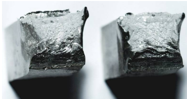
Slika 4.35 Prelomljena površina uzorka 1Ti4Si
