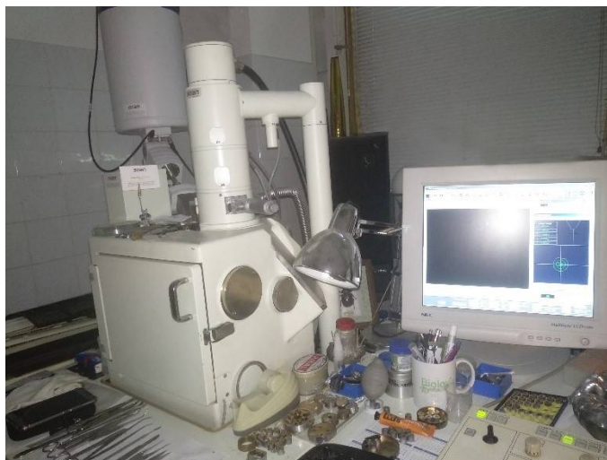
Slika 3.54 Skening elektronski mikroskop JEOL JSM 6460LV
