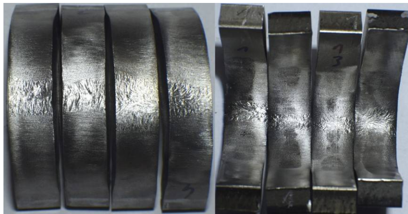
Slika 4.30 Uzorci zavareni sa aktivnim premazom 1% TiO_2 + 4% SiO_2 nakon savijanja prikazani sa obe strane
