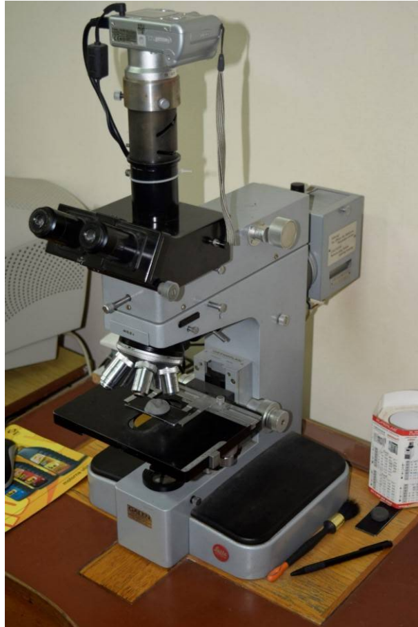
Slika 3.52 Svetlosni mikroskop LEITZ-Orthoplan
