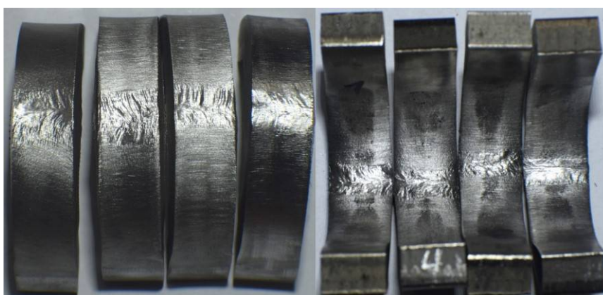
Slika 4.27 Uzorci zavareni sa aktivnim premazom 4% TiO 2 + 1% SiO 2 nakon savijanja prikazani sa obe strane
