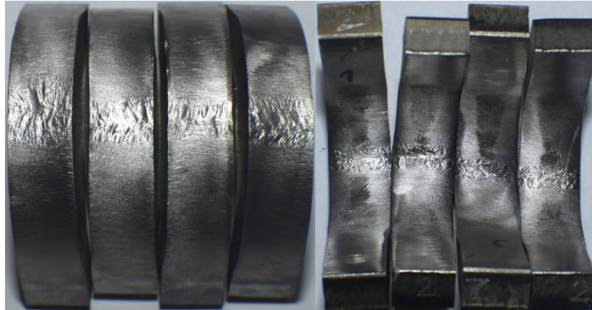
Slika 4.29 Uzorci zavareni sa aktivnim premazom 2% TiO_2 + 3% SiO_2 nakon savijanja prikazani sa obe strane
