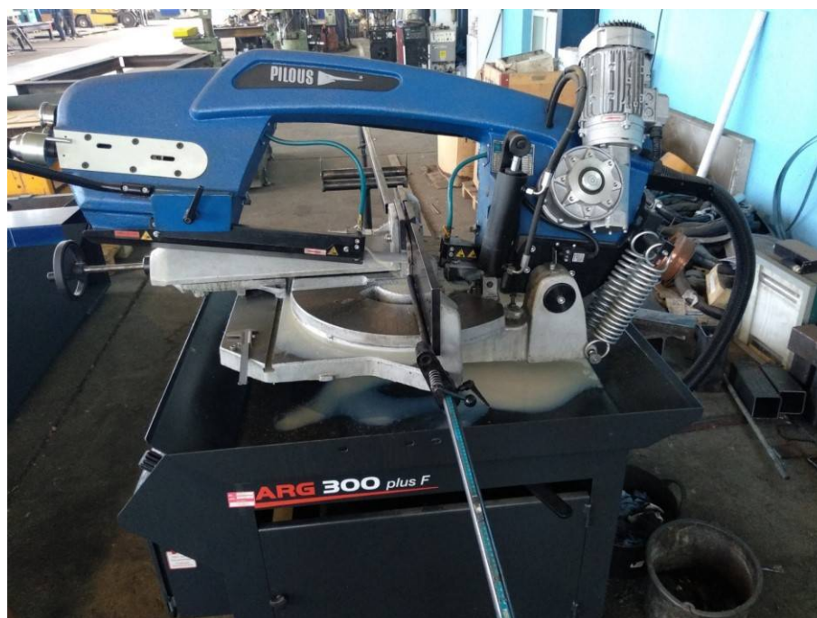
Slika 3.50 Trakasta testera Pilous ARG 300 plus F
