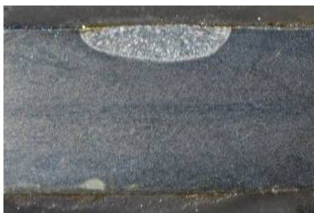
Slika 3.23 Makro izgled metala šava nakon pretapanja uzorka bez premaza
