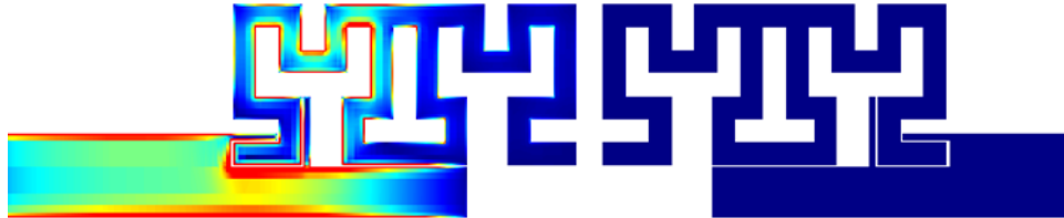
Slika 7.7: Raspodela struja u filtru na učestanosti na kojoj se javlja transmisiona nula.
